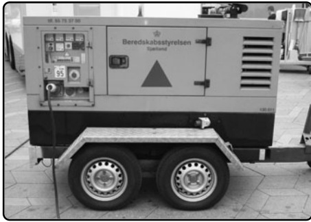
FIGURA 8. Los generadores eléctricos funcionan con combustible diesel o similar.
