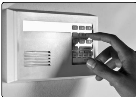
FIGURA 19. Muchos sistemas de alarma cuentan con un teclado numérico que permite activarlo y desactivarlo.
