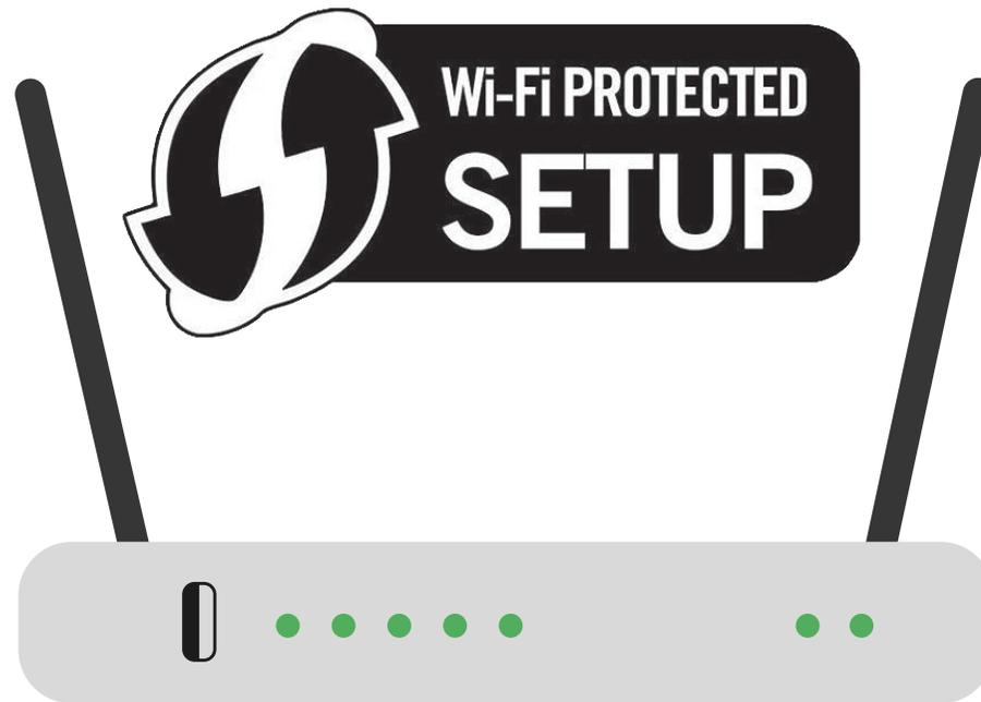
Para conectarse, el dispositivo debe transmitir un **código numérico** (generalmente de 8 dígitos) al router. A cambio, el router le envía los datos necesarios para que el primero pueda conectarse a la red.
