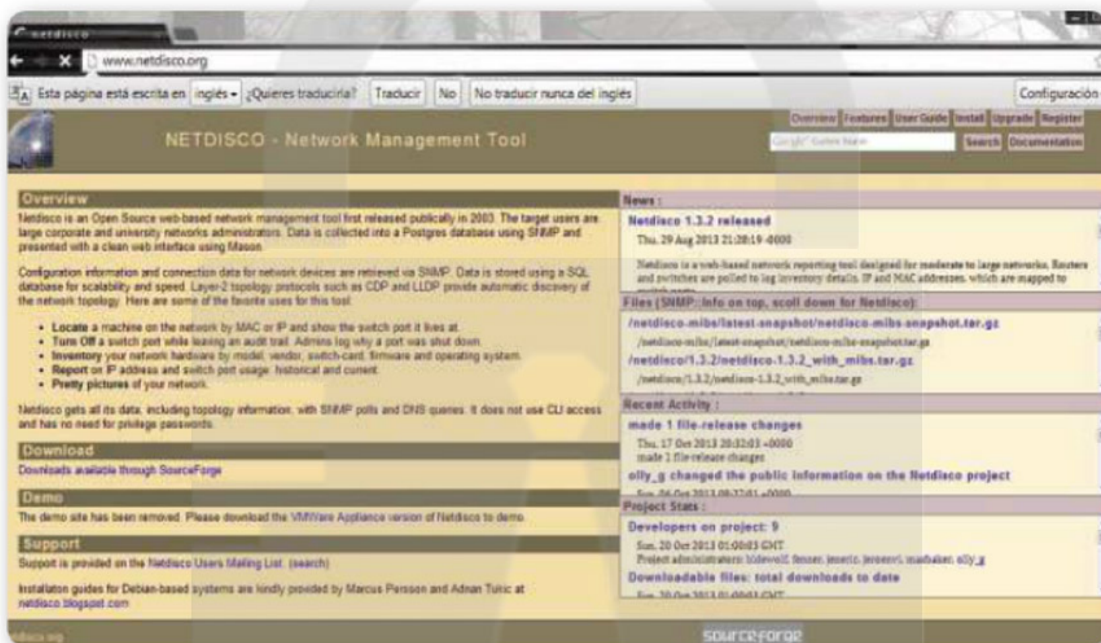
Figura 4. Netdisco ( www.netdisco.org ) es un software de código abierto que mantiene un inventario de los dispositivos de red existentes. Puede detectar nuevos dispositivos a través de SNMP , CDP y LLDP .
