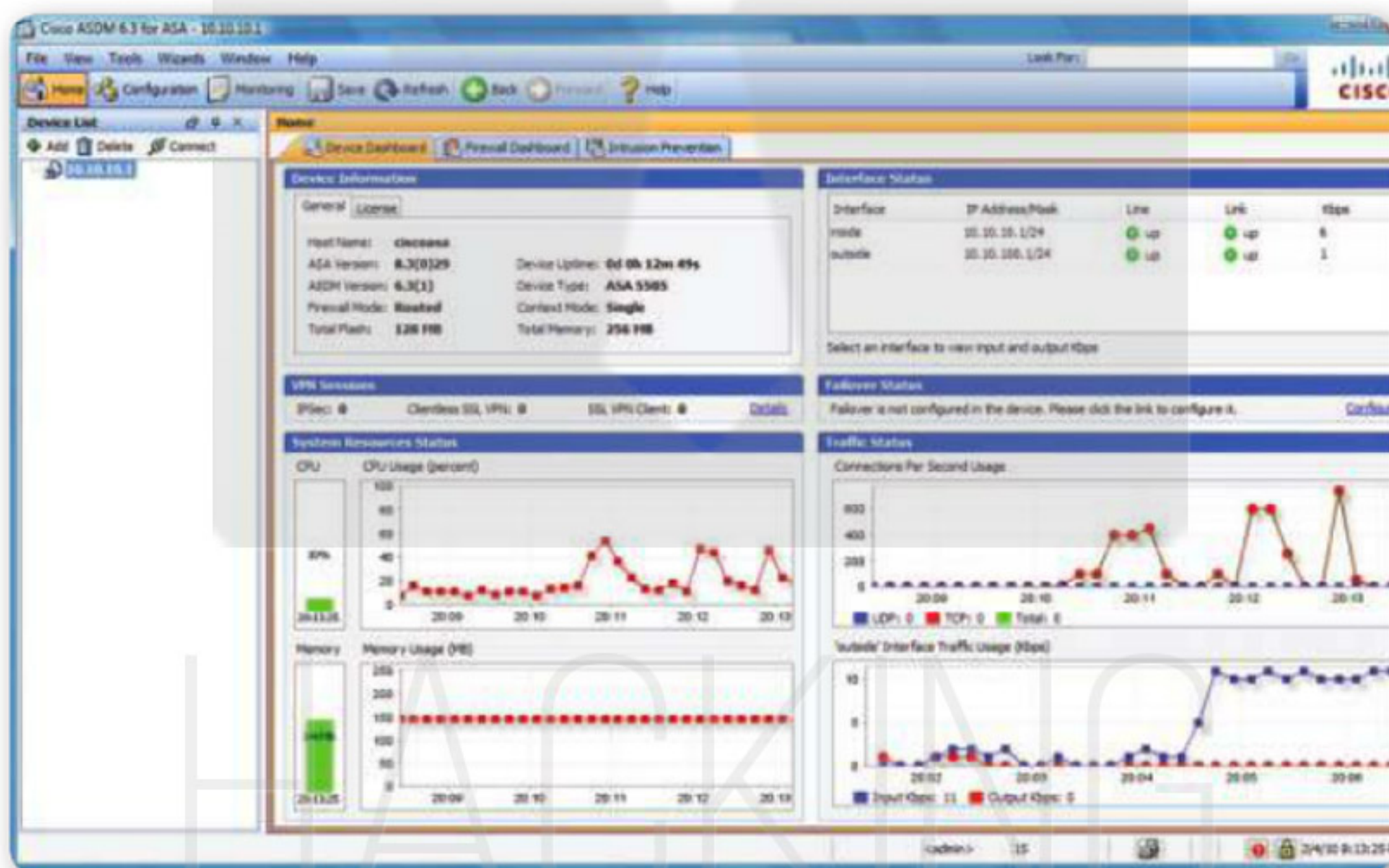
Figura 18. ASDM es una herramienta desarrollada por Cisco, que ofrece la capacidad de gestionar sus dispositivos de seguridad. El cliente se ejecuta sobre plataformas Microsoft Windows.
