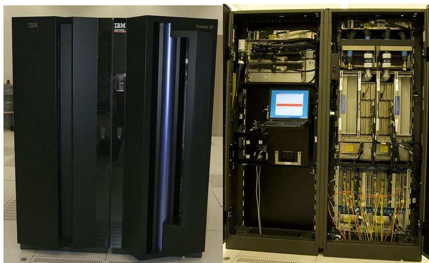
Figura 1.3 (a) Parte frontal e interior del mainframe IBM 2094 System z9, que corre actualmente desarrollos de máquinas virtuales utilizadas en los primeros mainframes con virtualización de IBM.
