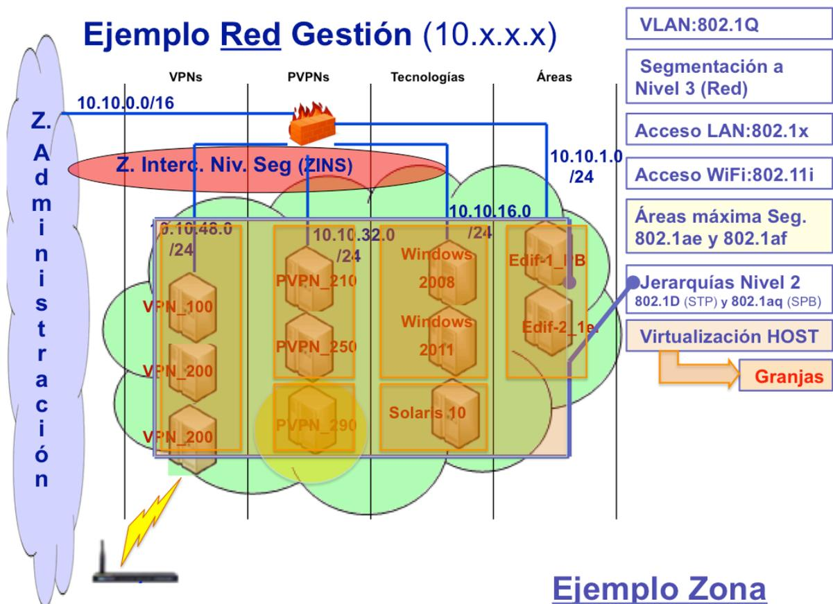
Imagen ejemplo de una red segmentada, 802.1Q, 802.1x, 802.11i, 802.1ae, 802.1af, 802.1D, 802.1aq y virtualización de hosts
