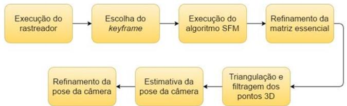
Figura 4. Pipeline de reconstrução 3D de acordo com [14].
