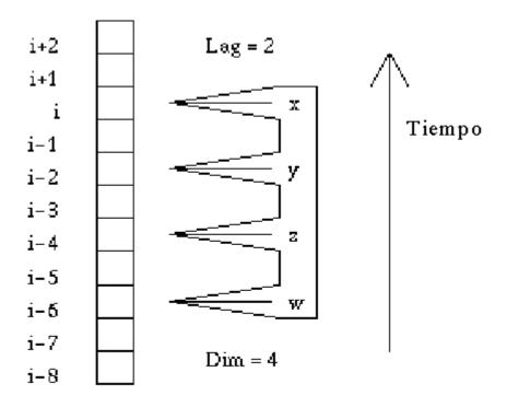
Figura 1. Método de retardos para la construcción de vectores.
