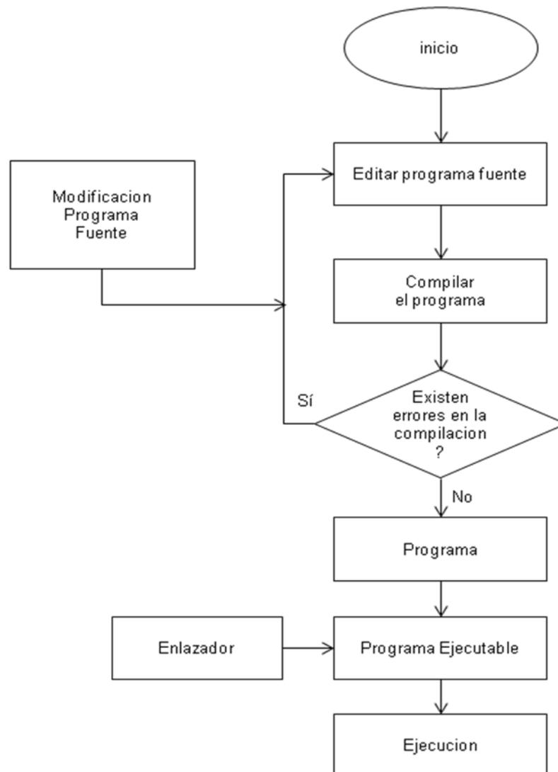
Figura 1.4.5. Fases de ejecución de un programa.
