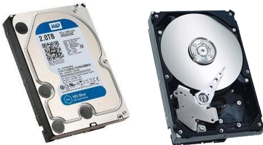
**Estructura:** Un disco rígido se compone de varios platos y estos, a su vez, se componen de pistas y sectores. La combinación de ambos dan como resultado los clústeres, como se puede apreciar en la siguiente imagen:
