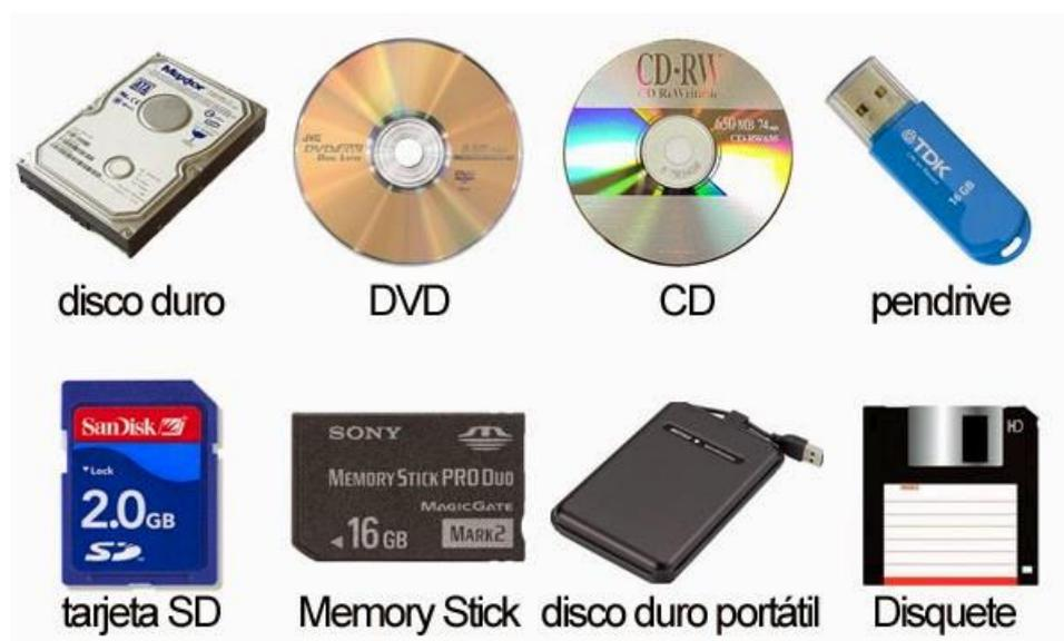
**Nota:** La memoria “Flash” es aquella que graba y elimina datos mediante impulsos electrónicos. Un ejemplo de este tipo de memoria es el pendrive.
