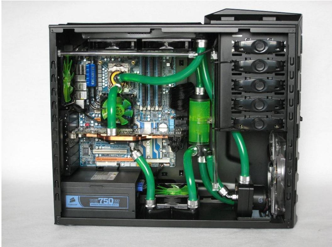
**Nota:** El agua, y cualquier líquido refrigerante, tienen mayor capacidad térmica que el aire. A partir de este principio, la idea es extraer el calor generado por los componentes de la computadora usando como medio el agua, enfriarla una vez fuera del gabinete y luego reintroducirla.
