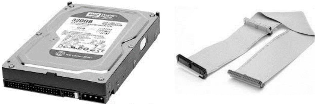
Fig. 1 Disco Duro IDE con su bus de Datos
