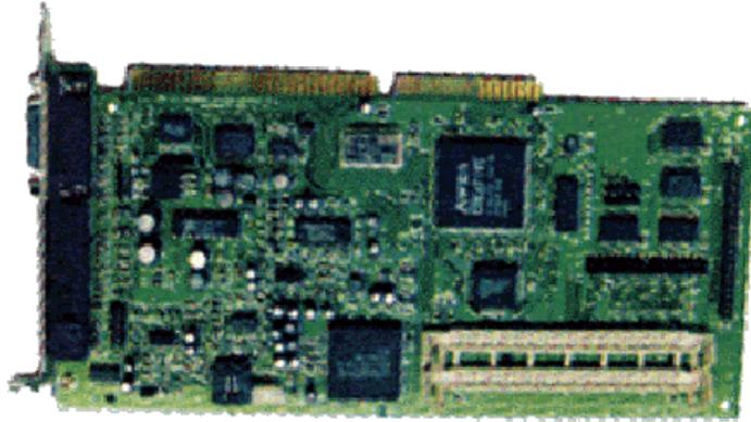
En WaveTable se usan grabaciones de instrumentos reales, produciéndose un gran salto en calidad de la reproducción, ya que se pasa de simular artificialmente un sonido a emitir uno real. Las tarjetas que usan esta técnica suelen incluir una memoria ROM donde almacenan dichos "samples"; normalmente se incluyen zócalos SIMM para añadir memoria a la tarjeta, de modo que se nos permita incorporar más instrumentos a la misma.
