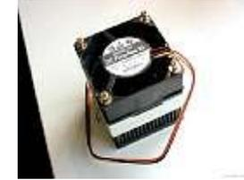
Aquí tenemos el disipador con su ventilador armado
