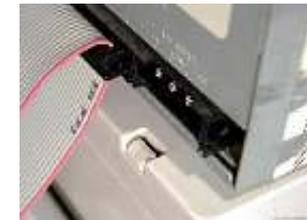
Se coloca con el borde rojo a hacia el conector de alimentación
