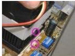
Ahora enganchamos la parte articulada del clip del disipador en la uña del zócalo de plástico de la CPU
