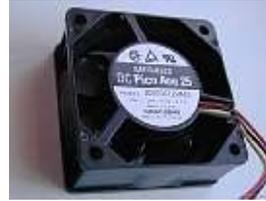
Este es el ventilador del disipador de calor
