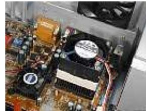
Foto antes de enganchar el disipador en el zócalo del procesador
