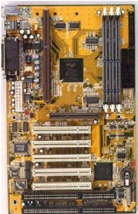
Se las supone de más fácil ventilación y menos maraña de cables que las Baby-AT, debido a la colocación de los conectores. Para ello, el microprocesador suele colocarse cerca del ventilador de la fuente de alimentación y los conectores para discos cerca de los extremos de la placa.
