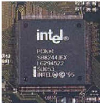
El "chipset" es el conjunto (set) de chips que se encargan de controlar determinadas funciones del ordenador, como la forma en que interacciona el microprocesador con la memoria o la caché, o el control de puertos PCI, AGP, USB...
