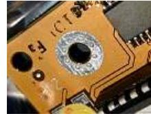
Fotos de las ranuras por don se colocaran los tornillos de fijación de la placa base
