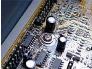
Tornillo de montaje en la placa base
