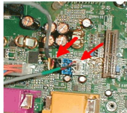
escucharlo a través de nuestros altavoces. En la foto inferior izquierda podemos ver rodeado por un círculo el cable conectado, ese cable se conectará a la tarjeta de sonido en una de las tomas CD-IN o AUX-IN. En este caso como tenemos un lector y una grabadora conectaremos uno al CD-IN y otro al AUX-IN, como podemos ver en la foto de la derecha.
