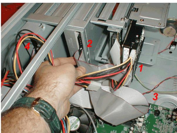
1. Hemos conectado el cable de datos al disco duro, el hilo rojo del bus se encuentra conectado al lado del de alimentación. Hemos utilizado el conector del extremo, el que dice master.
