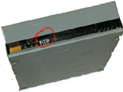
La forma de configurar CD-ROM y grabadora como maestro/esclavo es la misma que en el caso de los discos duros, mediante jumpers.
