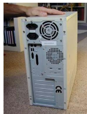
del borde de la cubierta en la parte posterior, sin embargo en algunos, los tornillos están detrás de la cubierta frontal de plástico o bisel.
