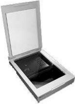
El escáner es un periférico que permite digitalizar imágenes o texto y almacenarlos en el disco duro del computador, para su actualización mediante una serie de aplicaciones específicas.
