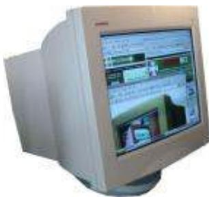
Para poder utilizar el monitor se requiere una tarjeta gráfica conectada a la tarjeta madre del computador, ésta envía al monitor los datos que ha procesado a través del RAMDAC (define las frecuencias de refresco), el cual está encargado de transformar la información digital procesada por el equipo a formato analógico para que la entienda el monitor
