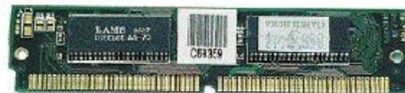
Los simms de 72 contactos tienen que ser instalados en pares, siempre llenando la primera y segunda ranura y/o la tercera y cuarta. Los dos simms de cada par tienen que ser de la misma velocidad y del mismo tipo. Por ejemplo, pueden formar
