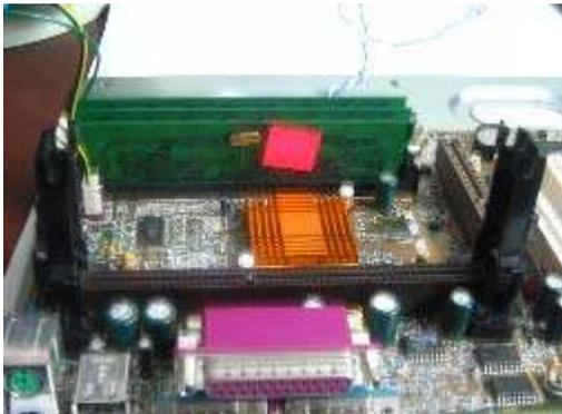
Encuentre el Slot 1 del procesador en su tarjeta madre. Es una larga ranura negra, de unos 13cm de largo. Para que el cartucho del procesador se sostenga firmemente, necesita fijar dos rieles verticales en los extremos de la ranura antes de insertarlo. Son negros, plásticos y de unos 6,5cm de alto; deben venir dentro del empaque de su tarjeta madre. Para fijar cada riel, introduzca los tornillos de su base en los hoyos de la tarjeta madre situados a los lados de cada extremo de la ranura.
