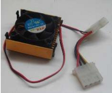
Para que el procesador no exceda su máxima temperatura, necesita colocarle encima un disipador de calor y un pequeño ventilador. Generalmente disipador y ventilador vienen juntos, ya atornillados de la manera conveniente. Si no, monte el ventilador sobre el disipador y atorníllelo, insertando tornillos en los cuatro agujeros del ventilador y enroscándolos entre las ranuras del disipador. Este conjunto tiene un cable sujeto que luego será conectado
